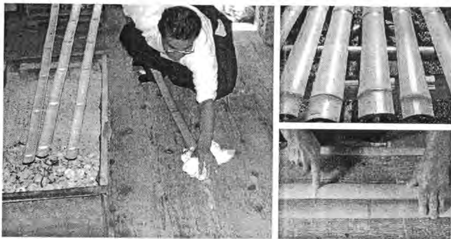
V. l. n. r.u.: Über einem rechteckigen Kohlebecken werden Bambuslatten erhitzt und dadurch entölt. | Der Bambus wird an der Sonne getrocknet. | Die Knoten zweier Bambuslatten werden genau aufeinander abgestimmt und die Länge wird festgelegt.
