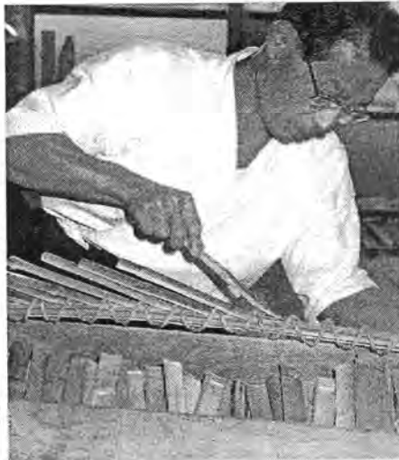
V. l. n. r.: Die zusammengesetzten Teile werden sofort nach dem Verleimen fest mit einem Seil umwickelt. | Nur auf der Seite des Innenbambus werden Keile eingefügt.
