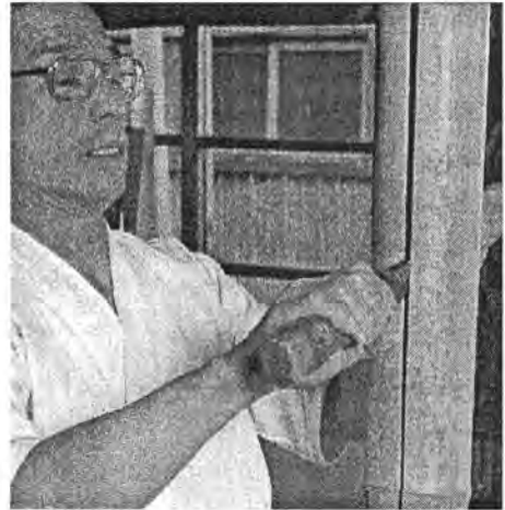
V. o. n. u.: Vom haze wird der gelbe Kernteil benutzt. | Der Bambus für das Kernholz wird zuerst halbiert und dann geviertelt, so dass man schließlich acht Teile erhält.
