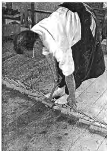
Das Kernholz, links mit einer Säge auf die richtige Breite zugeschnitten
