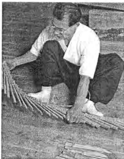
V. l. n. r.: Beim uchikomi kommt es auf das Gespür des Bogenbauers an. | Der Bogenbauer setzt seine ganze Körperkraft ein, um jeder Partie die gewünschte Krümmung zu geben.
