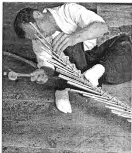
V. l. n. r.: Beim uchikomi kommt es auf das Gespür des Bogenbauers an. | Der Bogenbauer setzt seine ganze Körperkraft ein, um jeder Partie die gewünschte Krümmung zu geben.
