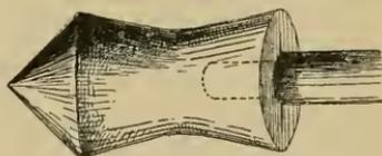
Fig. 8. Kolben „fushi-nuki“.
