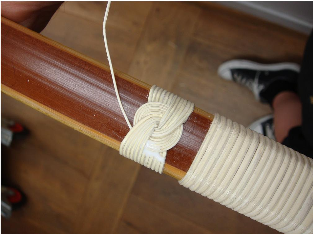
14) Oberflächlicher Leim wird nun schnell mit einem feuchtem Lappen abgewischt und das Band bündig mit der Wicklung abgeschnitten
